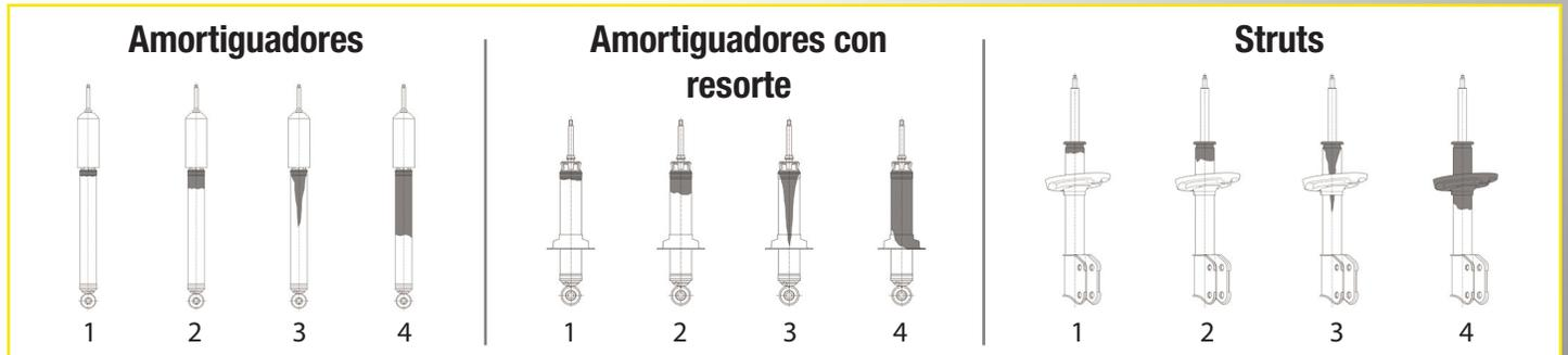
El aceite encontrado en las unidades 1 y 2 refleja filtración y no requiere reparación. Las unidades 3 y 4 reflejan fuga y requieren reemplazo.
